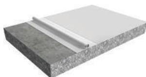
**Sikalastic®-614** è una membrana liquida poliuretanica monocomponente igro-innescata, tecnologia MTC, immediatamente resistente alla pioggia (10 min), UV resistente, ad elevata elasticità, applicabile a freddo. Una volta indurita, realizza un sistema continuo, impermeabile e duraturo per coperture a vista. Conforme ai requisiti ETAG-005-6 (W2 = 10 anni).
